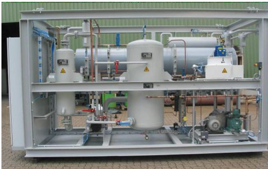
**Рис. 4.2 Система удаления масла и газа**
