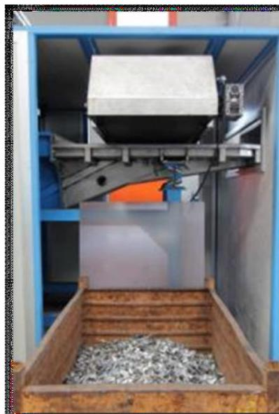
Рис. 4.5 Магнитный сепаратор
