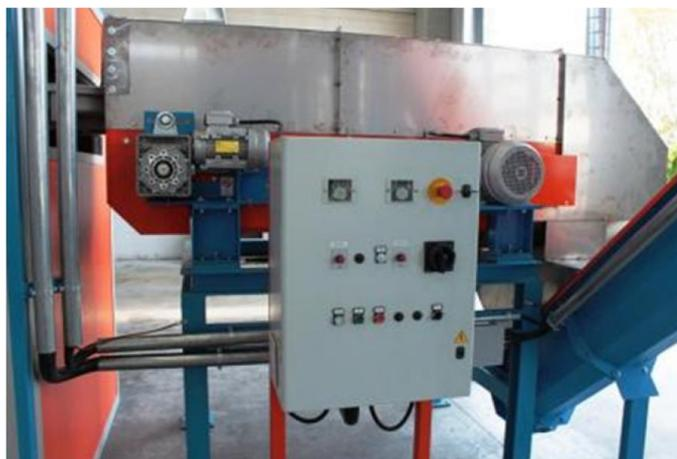
**Рис. 4.7 Вихревой сепаратор**
