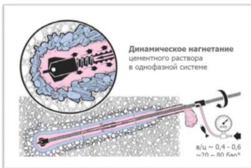
Рис.2 Нагнетание цементного раствора
