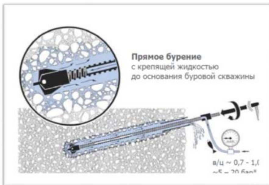
Рис.1 Бурение с промывкой
