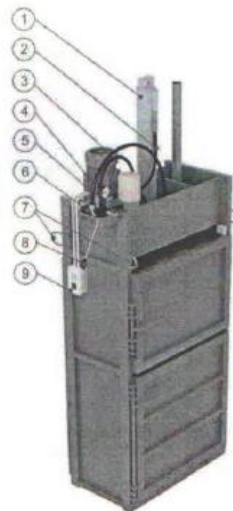
1. Гидроцилиндр 2. Маслопровод 3. Электрический двигатель 4. Манометр 5. Патрубок слива 6. Распределитель давления 7. Монтажное ухо 8. Ручка управления 9. Магнитный пускатель
