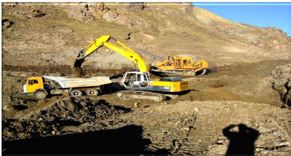
Рисунок 29 - Экскаватор LS 2 800 FLJ при погрузке горной массы в автосамосвал КамаЗ 55111
