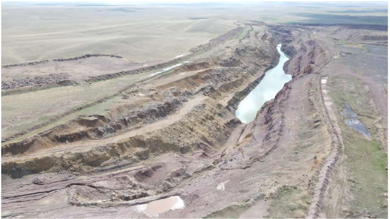
Рисунок 6.1.2 – Затопленная карьерная выемка в водоохранной зоне притока №1 реки Узынбулак, образовавшаяся в результате горнодобывающих работ
