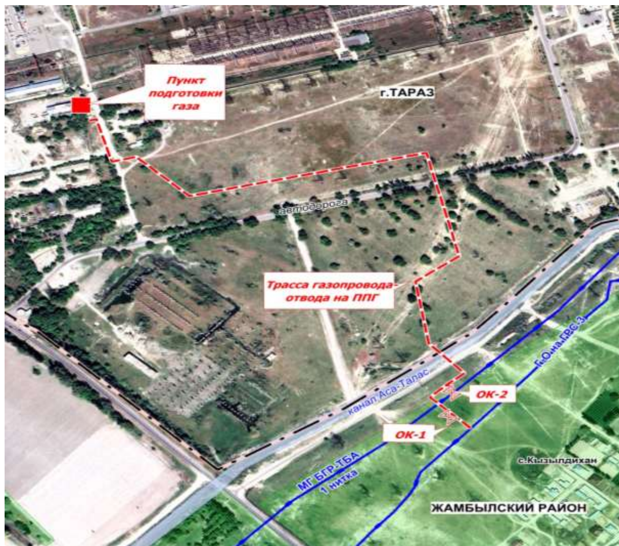
Рисунок 1.2. Схема трассы газопровода-отвода на ППГ «ЖГРЭС»
