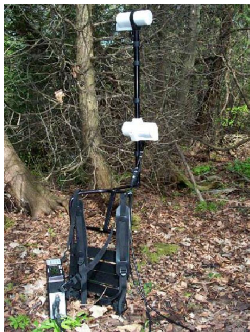
Рис. 5.11.1 Магнитометр GSM-19 в рабочем положении
