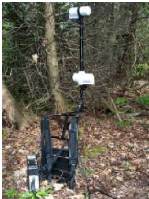
Рис. 5.11.1 Магнитометр GSM-19 в рабочем положении
