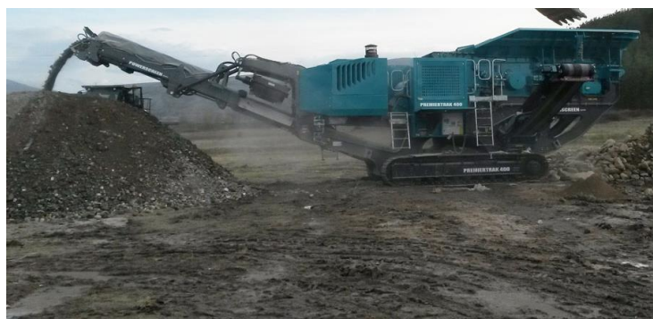
1 - самоходная щековая дробилка Premiertrak 400X
