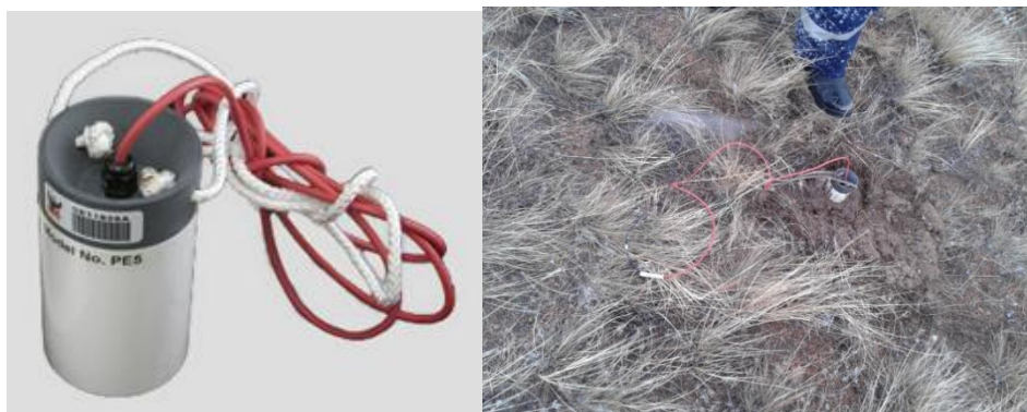
Неполяризующийся малошумящий электрод PE5
