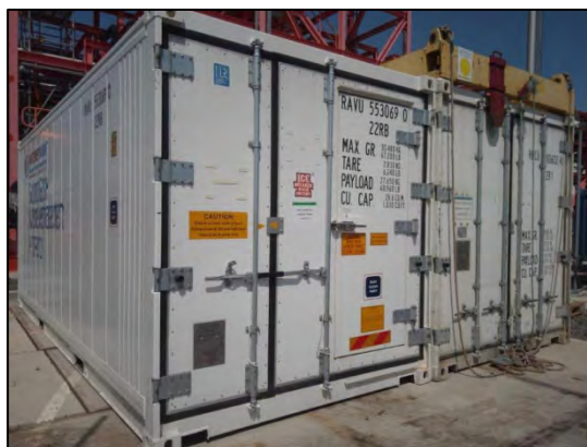
Фото 3 Морозильная установка контейнерного типа
