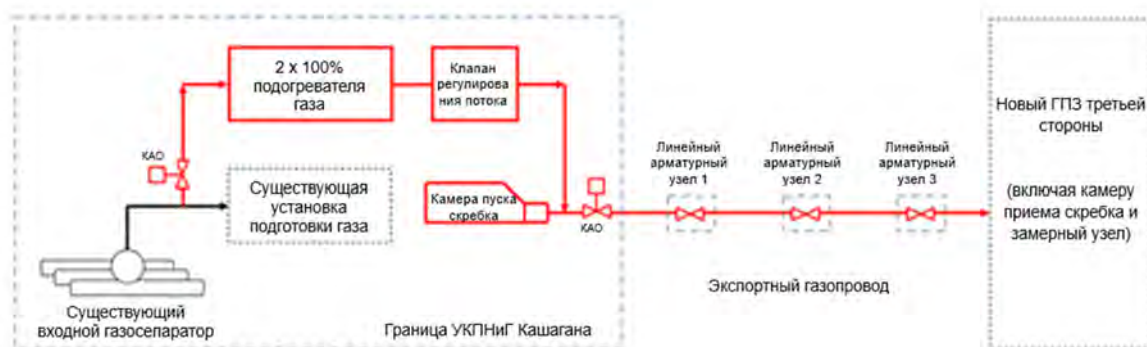
Рисунок 1.3.7 Принципиальная схема проекта передачи 1 млрд.м 3 газа в год
