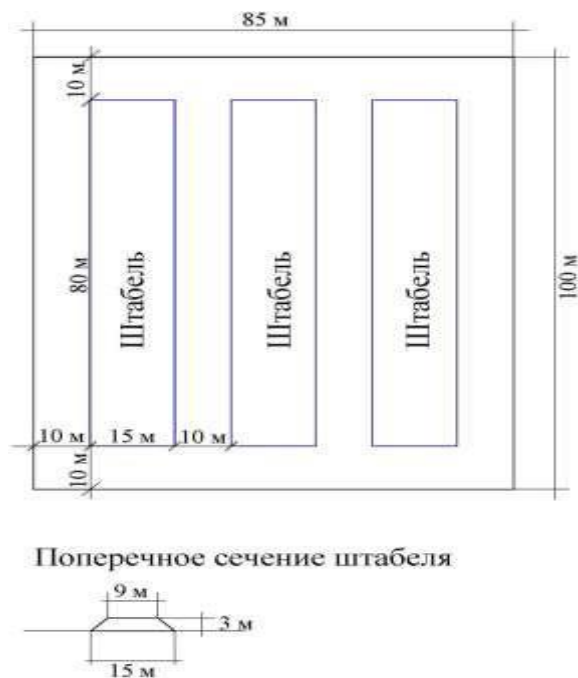
Рисунок 3.5.4.1 – Схема усреднительного рудного склада
