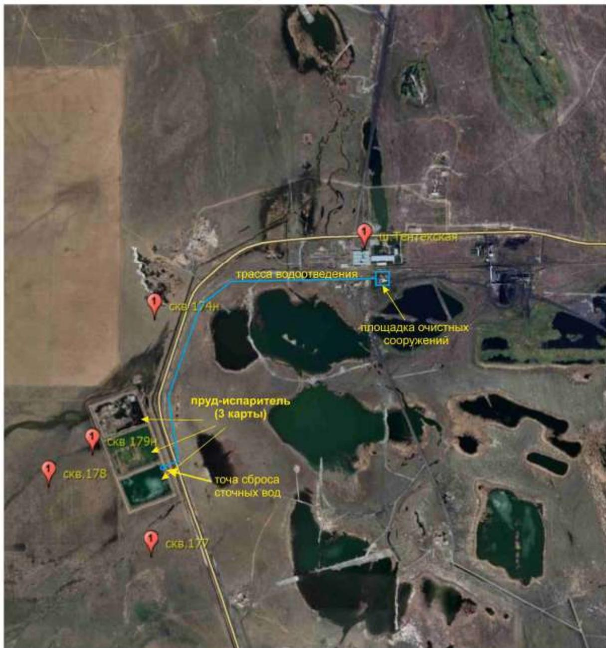
**Рисунок 2.1** Ситуационная карта-схема района расположения шахты «Тентекская» с указанием очистных сооружений, места выпуска и водоприемника сточных вод
