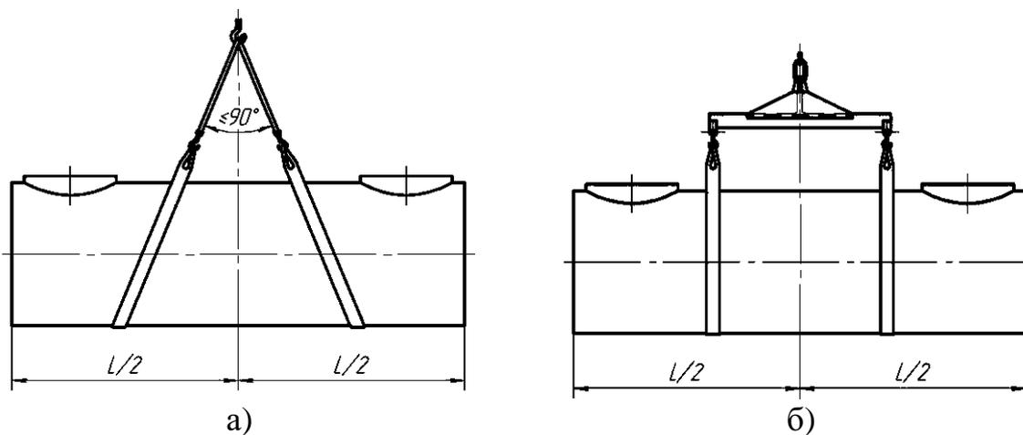
а – строповка текстильными стропами без применения специальных приспособлений; б – строповка текстильными стропами с применением траверсы
