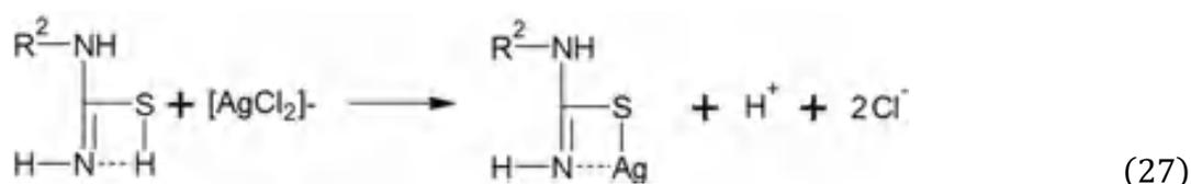
Насыщенный сорбент подвергается десорбции [39] сернокислым раствором тиомочевины, при этом протекает следующая реакция:
