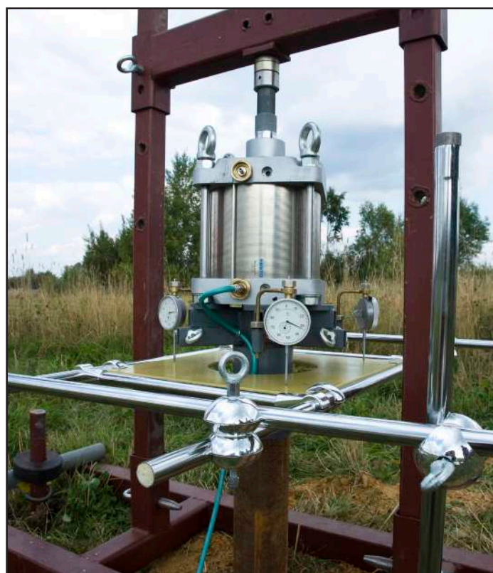
Рис.3. Позиционирование комплектующих штампа ШБ60
