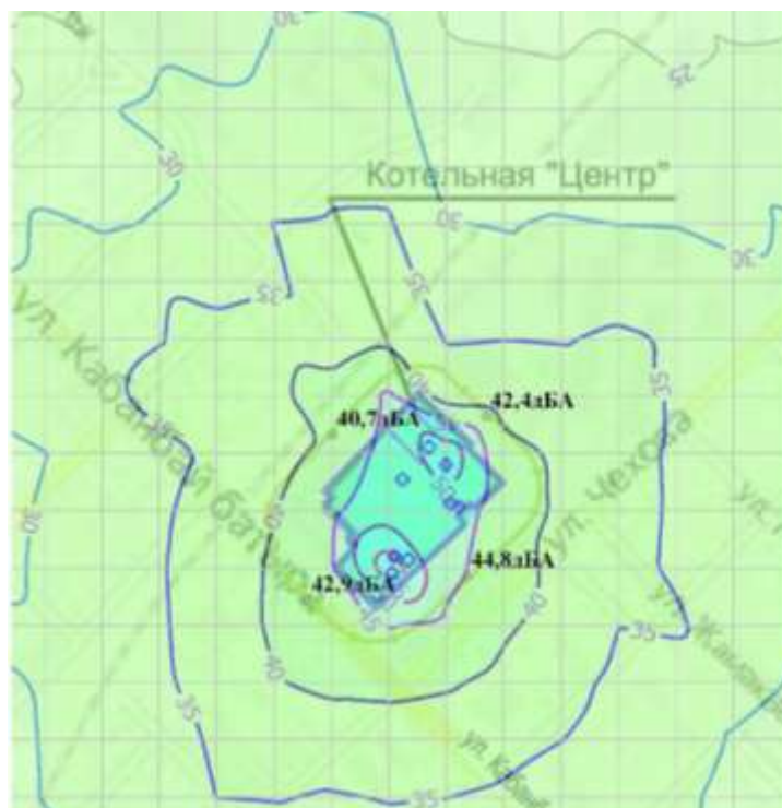
Рисунок 5.2.1. Карта акустического воздействия Котельной «Центр» после реконструкции
