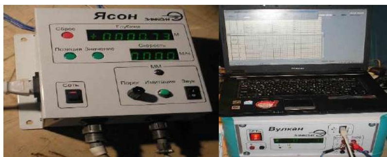
Рис. 6. Наземная регистрирующая аппаратура для ПРК-4203
