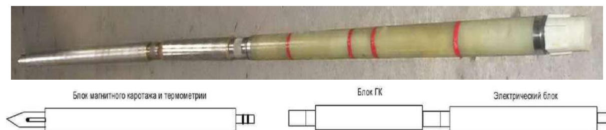
Рис. 5. Каротажный скважинный снаряд ПРК-4203
