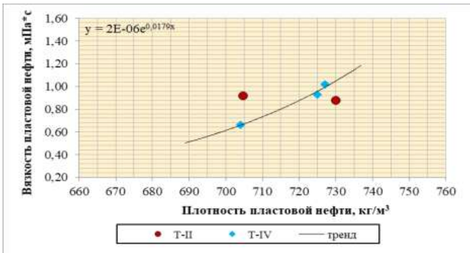
Рисунок 2.3. 3-Зависимость объемного коэффициента от газосодержания Рисунок 2.3. 4-Зависимость вязкости от плотности пластовой нефти
