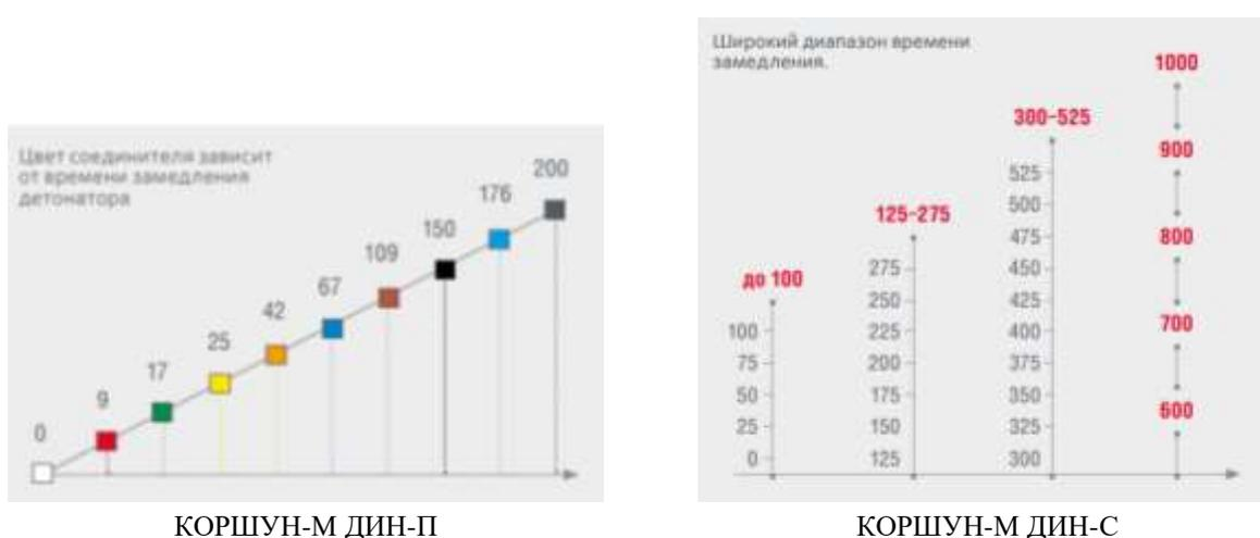
Рисунок 3.41- Время замедления неэлектрические система инициирования
