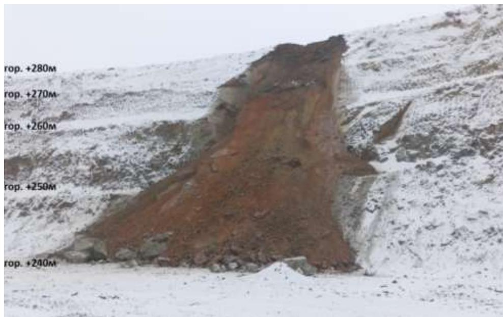
Рисунок 3.6 Конечная стадия обрушения
