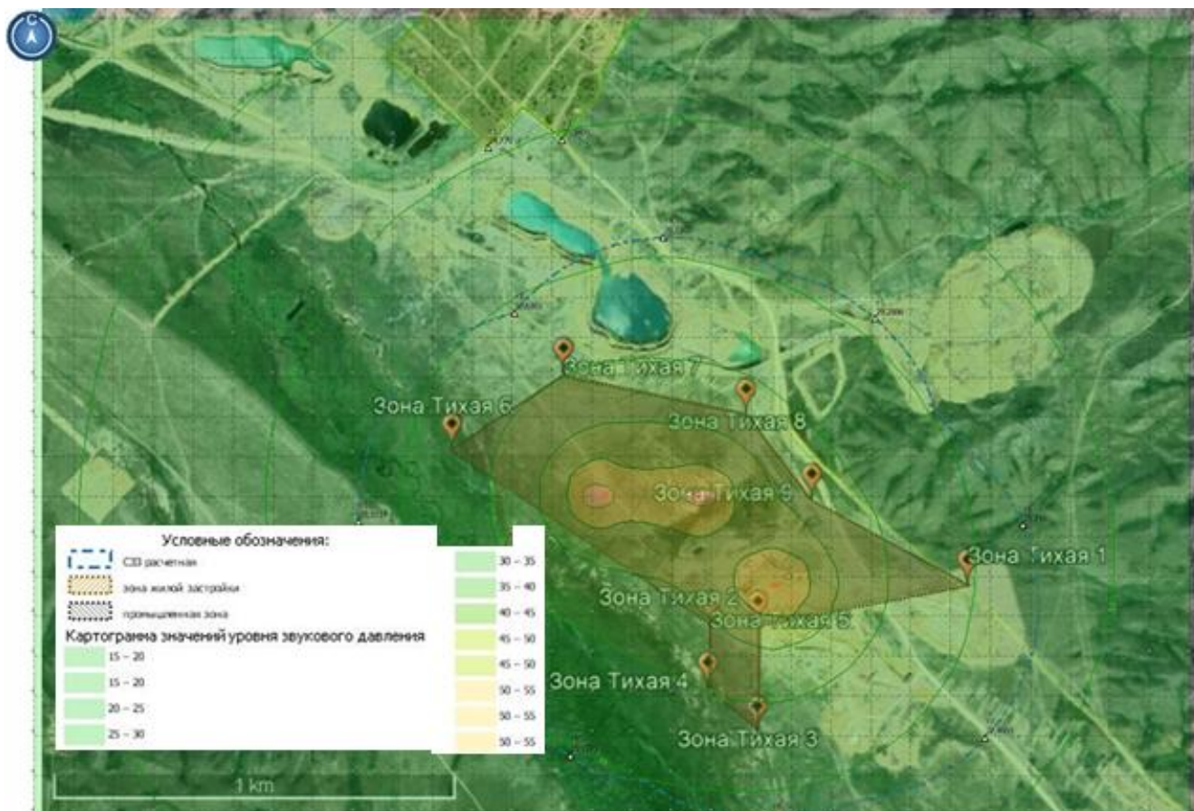
Рисунок 4 – Результаты расчёта затухания шума на границе нормативной СЗЗ и ближайшей жилой зоны
