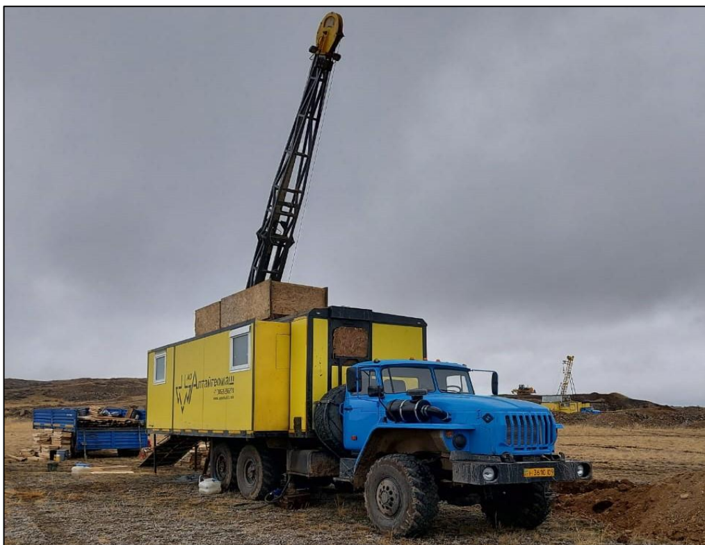
Рис. 5.2 Буровая установка на базе автомобиля УРАЛ 4320
