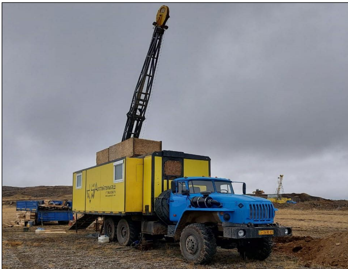
Рис. 5.2 Буровая установка на базе автомобиля УРАЛ 4320
