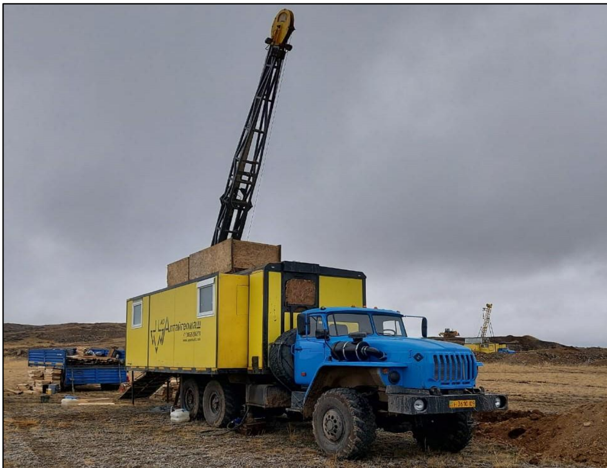
Рис. 5.1 Буровая установка на базе автомобиля УРАЛ 4320
