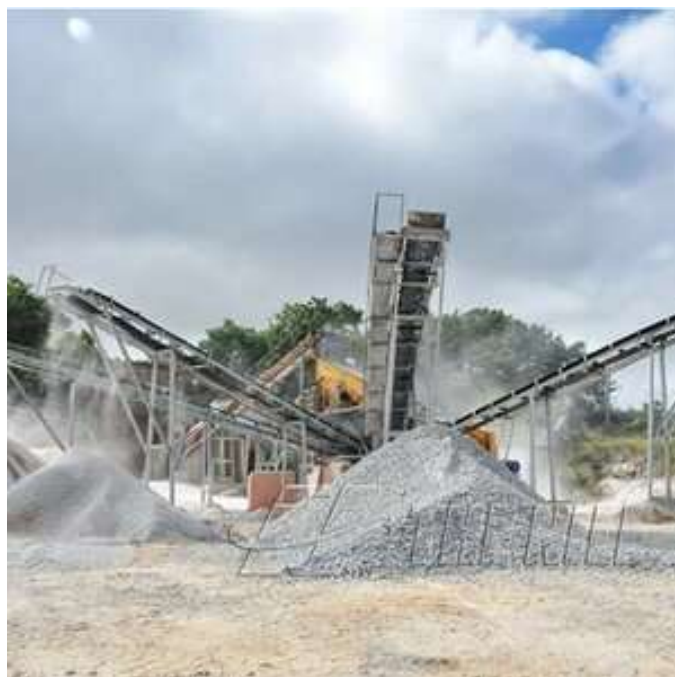
Рисунок 8 – Передвижная мобильная дробильно-сортировочная установка «Sandvik UJ 440i»
