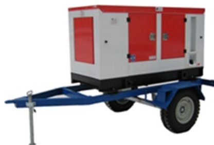
Рис. 7.2 - Передвижная дизельная электростанция типа ЭД 16-Т400-1РП
