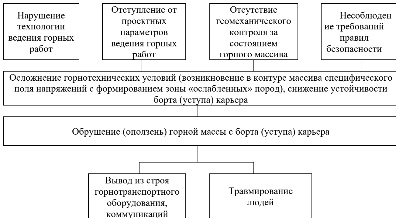
Рис.11.2 - Блок-схема вероятного сценария аварии при обрушении (оползней) горной массы с борта (уступа) карьера
