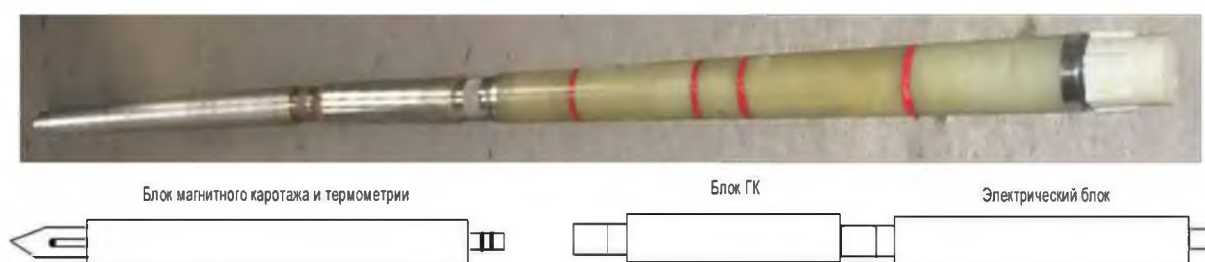
Рис. 5. Каротажный скважинный снаряд ПРК-4203
