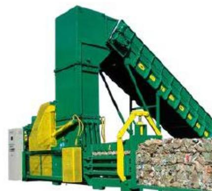
9. В этом прессе материалы пригодные для вторичной переработки (такие как: картон, макулатура, полистирол, алюминий, ПЭТ, ПНД, ПВД и т.д.) спрессовывается и автоматически перевязывается проволокой в плотные кипы весом от 300 до 1000 кг.
