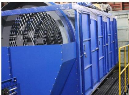
5. Остальной мусор выходит с торца грохота и попадает на утепленную платформу основной сортировки 20 постов № 9 смонтированную на эстакаде.
