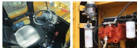
Кабина машины усилена, оборудована системами безопасности FOPS и ROPS.
