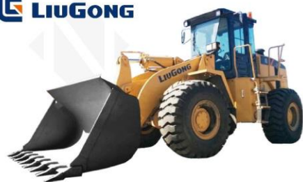
Кабина машины усилена, оборудована системами безопасности FOPS и ROPS.
