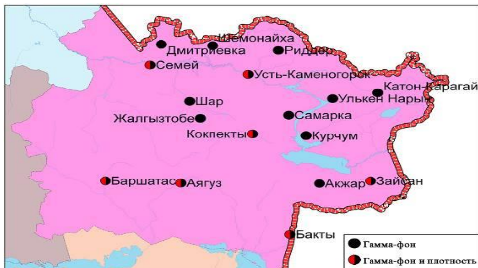
Рис. 1.18.12. Схема расположения метеостанций за наблюдением уровня радиационного гамма-фона и плотностью радиоактивных выпадений на территории ВКО и области Абай
