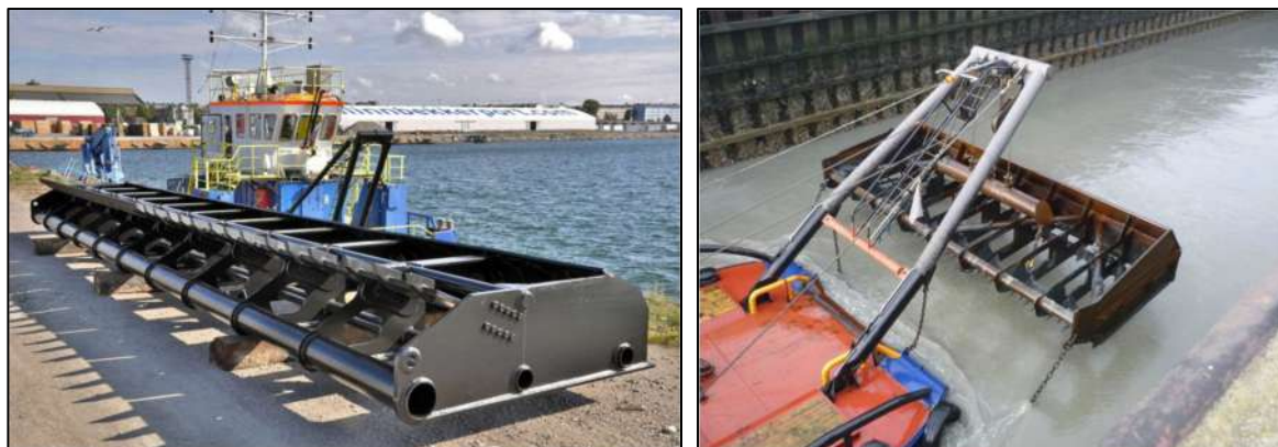
Рисунок 3.8 Пług (слева) и пług, подвешенный на раме на корме буксирного судна (справа)
