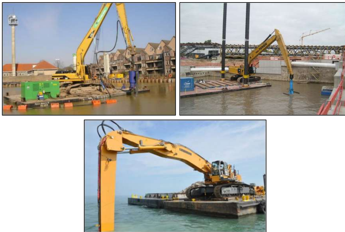
Рисунок 10.10 Механический земснаряд (МЗ) снизу, оснащенный ПЗС (слева) или грейферным ковшом (справа)
