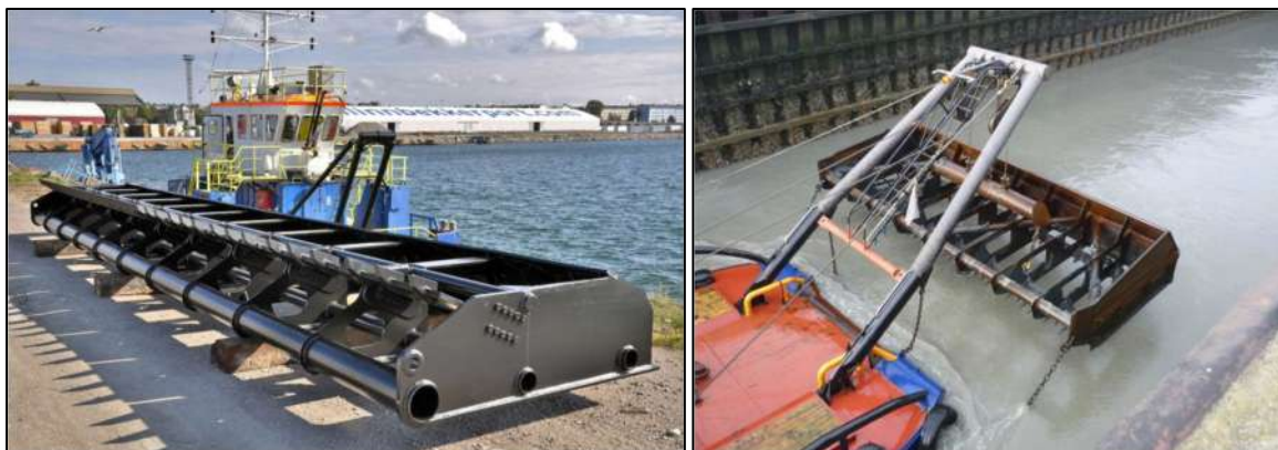
Рисунок 10.9 Пług (слева) и пług, подвешенный на раме на корме буксирного судна (справа)
