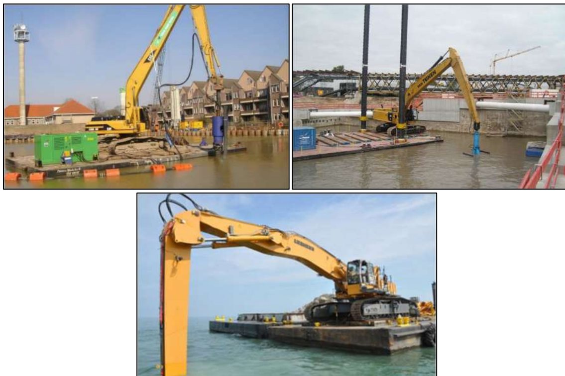
Рисунок 3.9 Механический земснаряд (МЗ) снизу, оснащенный ПЗС (слева) или грейферным ковшом (справа)
