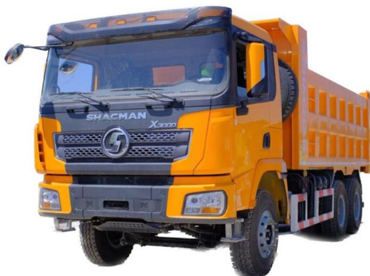
Рисунок 10– Самосвал SHACMAN X3000 грузоподъемностью 25 т
