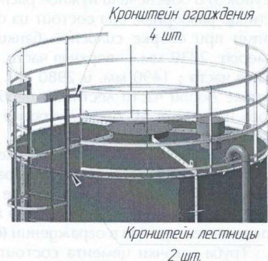
Рисунок 3 Схема рекомендуемого расположения ограждения и трубы заправки цемента
