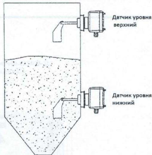
Рисунок 5 Схема установки датчиков силоса положения цемента
