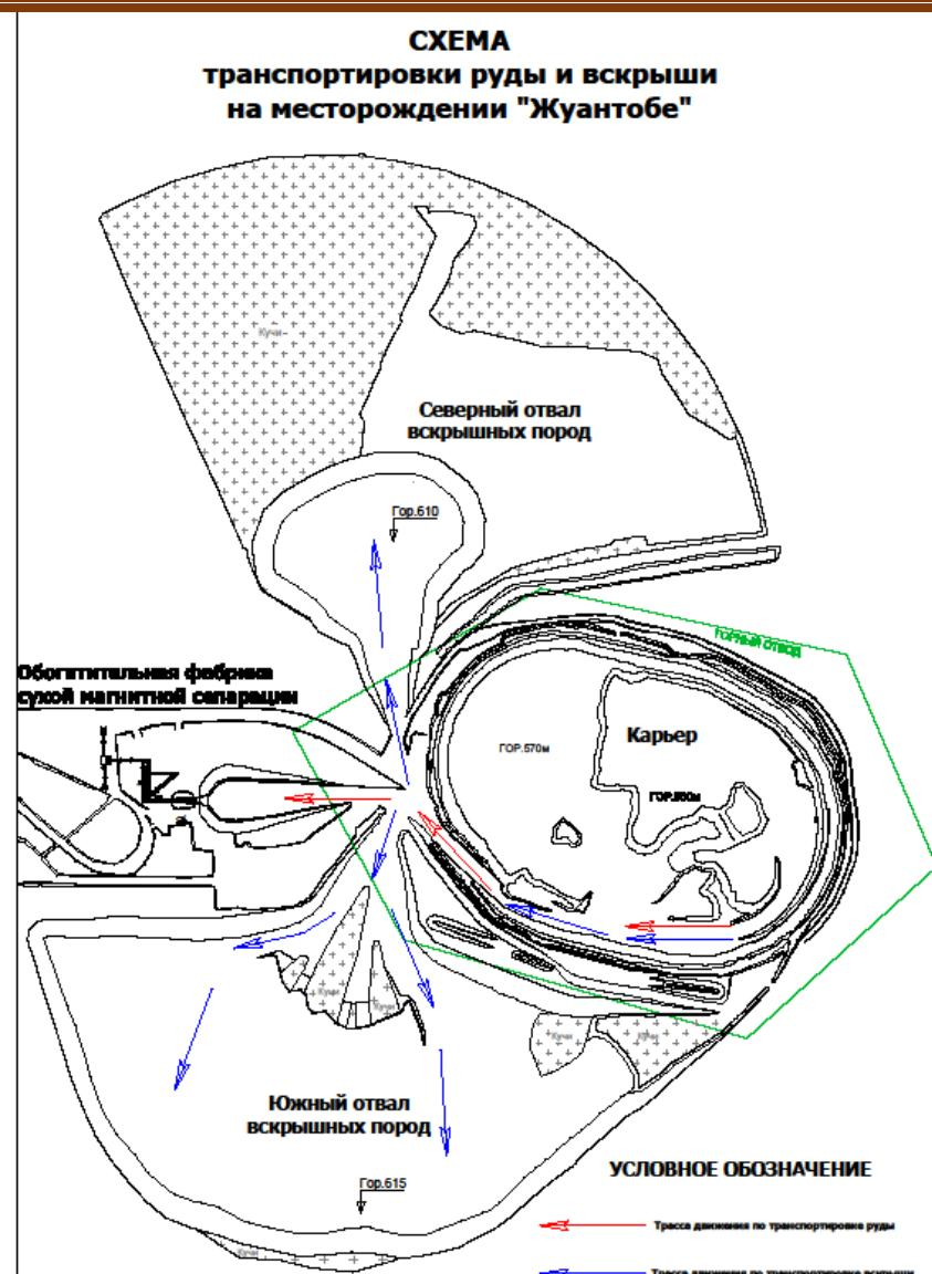
**Рисунок 5.2. Схема транспортировки руды и породы на месторождении Жуантобе**
