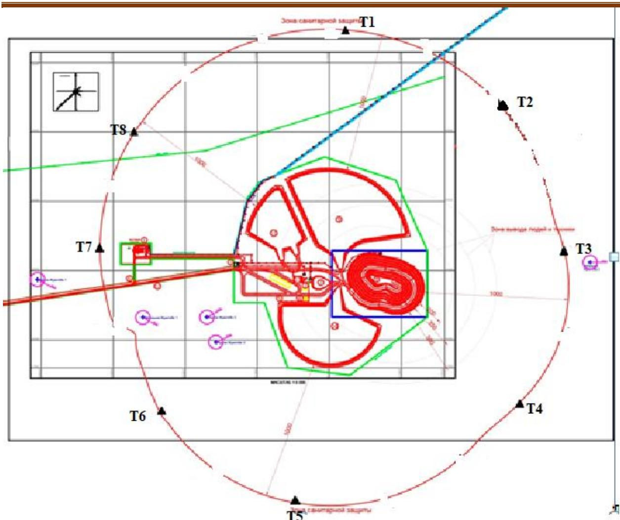
**Рисунок 8.1.1. Схема расположения точек наблюдения за атмосферным воздухом на руднике Жуантобе ТОО «Бапы Мэталс»**
