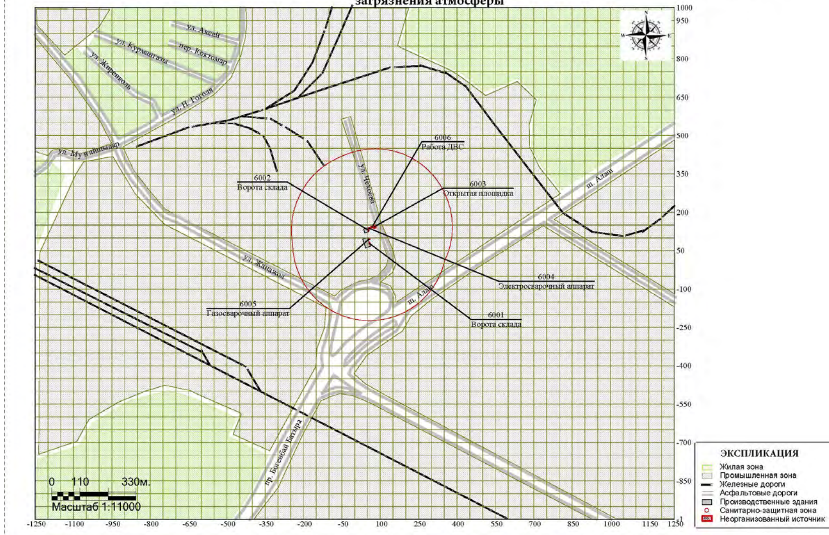
Ситуационная карта-схема района расположения производственных объектов пункта закупа и реализации лома цветных и черных металлов, а также сбора б/у аккумуляторов ТОО «Alliance LLP» с указанием источников загрязнения атмосферы
