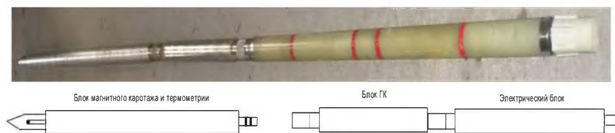
Рис. 5. Каротажный скважинный снаряд ПРК-4203
