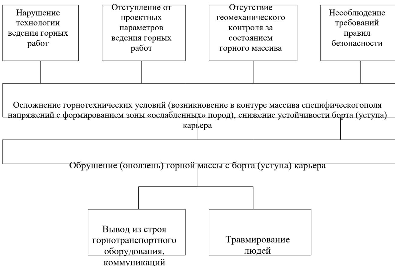
Рис.10.1 - Блок-схема вероятного сценария аварии при обрушении (оползней) горной массы с борта (уступа) карьера
