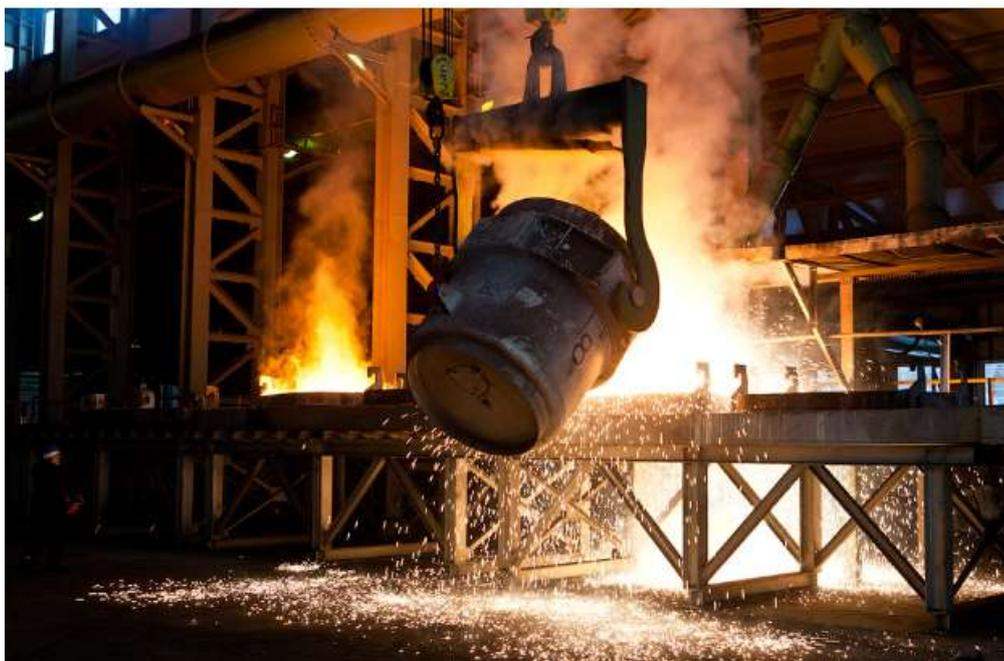
Рис. 14-Разлив жидкого технического кремния
