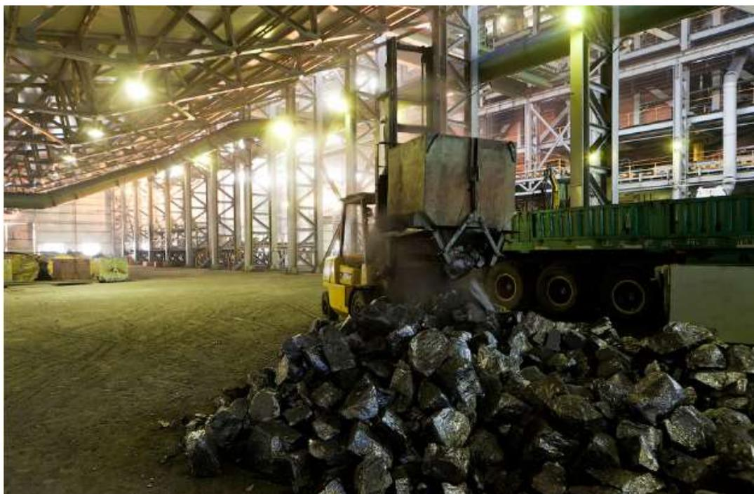
Рис.19-У разливочного стола предусматривается линия дробления и сортировки готовой продукции
