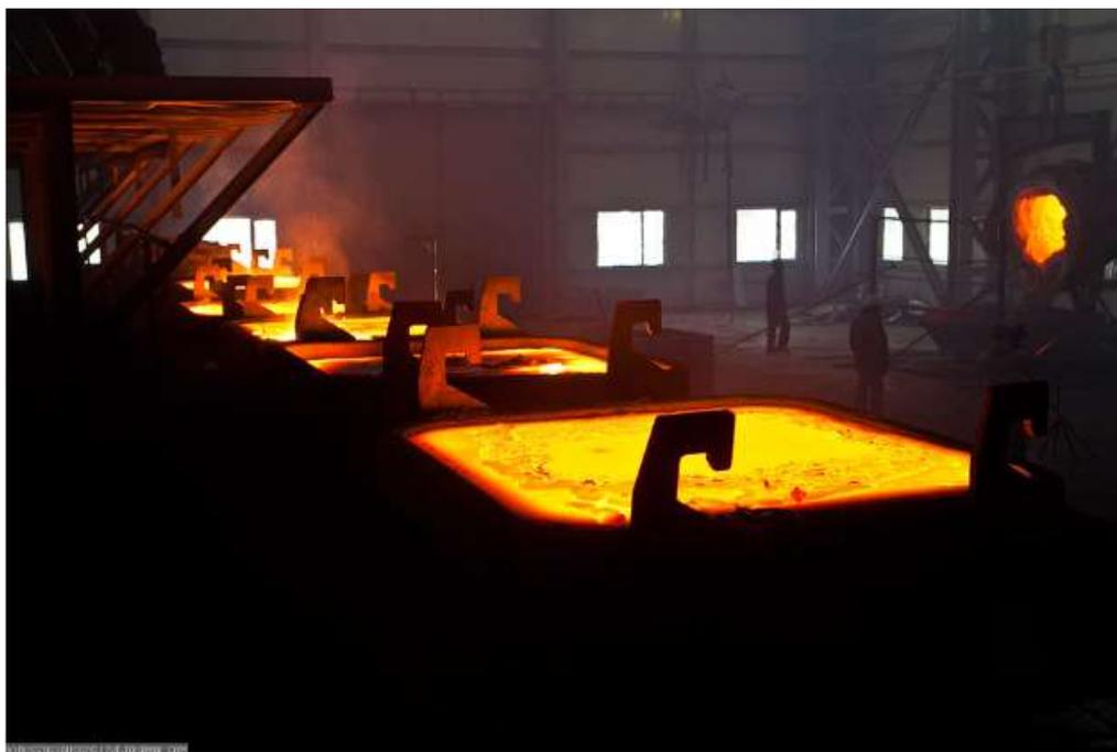
Рис. 15-Разливочные формы
