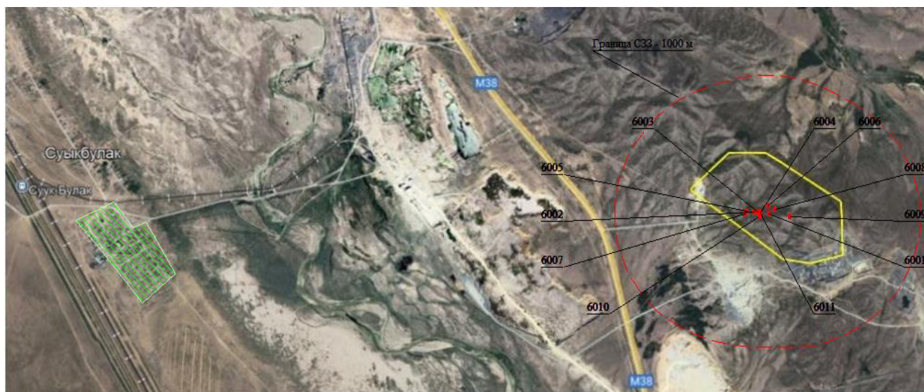
Рисунок 3 Карта-схема с нанесением источников выбросов в окружающую среду
