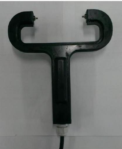
**Рис.3 - Датчик песка**
