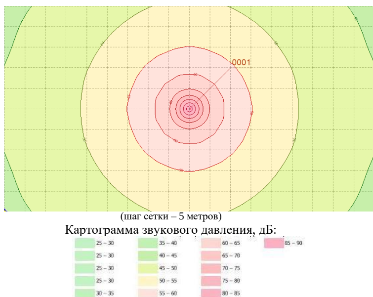
Рисунок 2 – Результаты расчёта затухания звука в графической форме в рабочей зоне оборудования при проведении разведочных работ (эквивалентный уровень звука – интегральный показатель)
