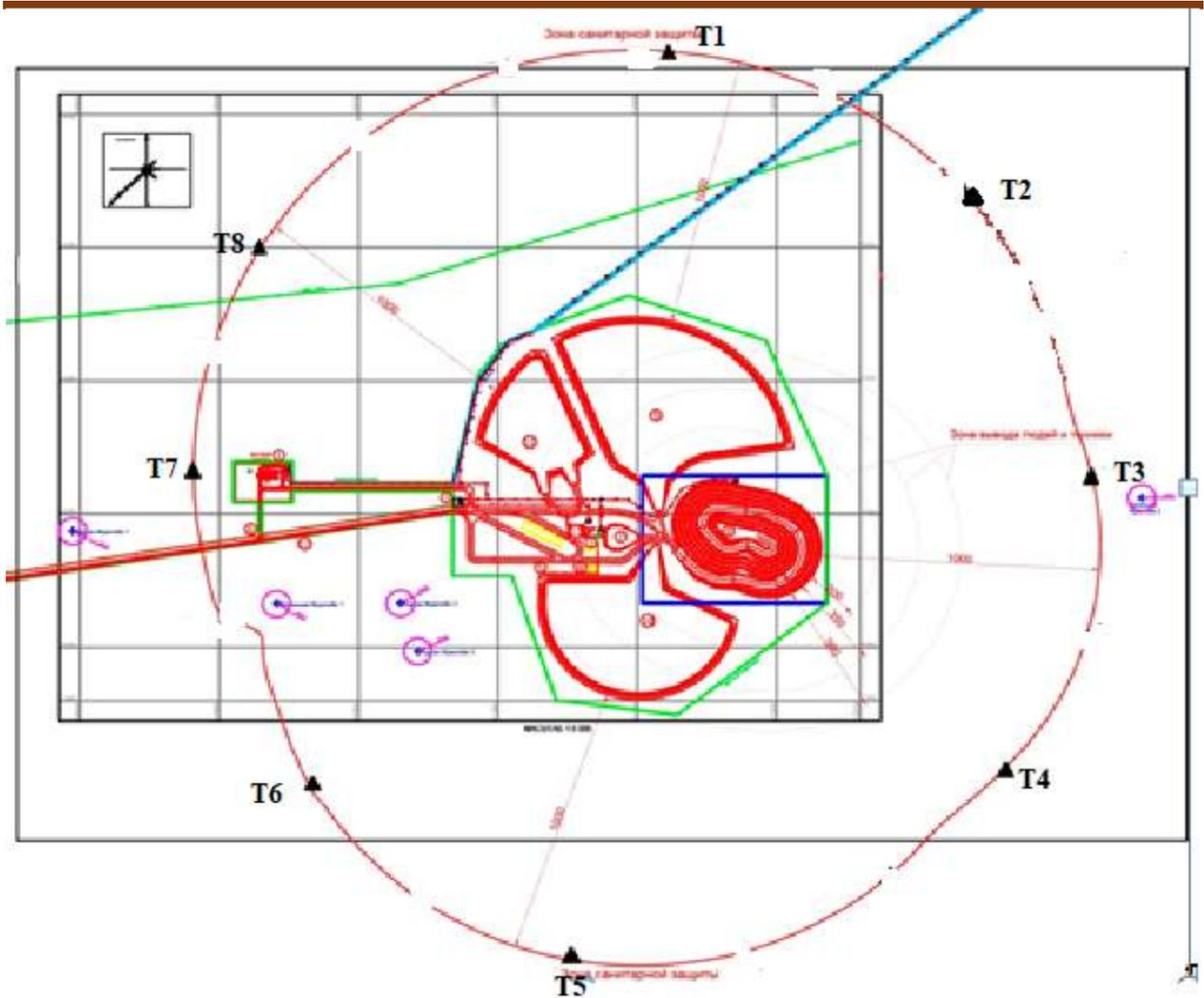
**Рисунок 8.1.1. Схема расположения точек наблюдения за атмосферным воздухом на руднике Жуантобе ТОО «Балпы Мэталс»**
