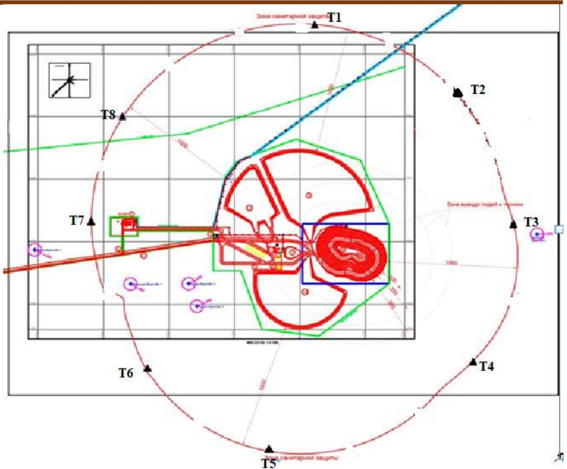
**Рисунок 9.1. Схема расположения точек наблюдения за атмосферным воздухом и почвой на руднике Жуантобе ТОО «Бапы Мэталс»**
