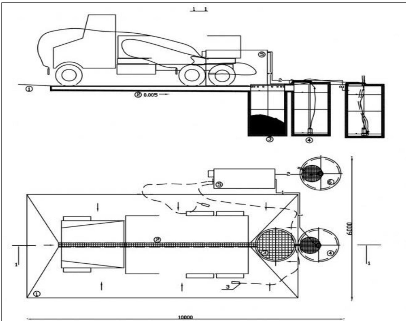
Обозначения: 1. Площадка бетонирования мойки колес; 2. Лоток водосборный, перекрытия решеткой; 3. Пескоулавливающий колодец, перекрытия съемной решеткой; 4. Насосная установка перекачки грязной моечной воды на очистку; 5. Установка оборотного водоснабжения "Свирь-15 мк"; 6. Грязесборный колодец.
