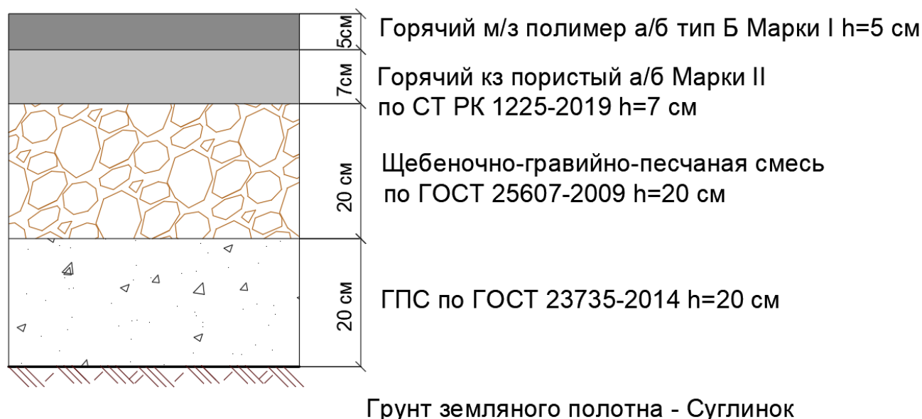
Рисунок. 4. Конструкция дорожной одежды
