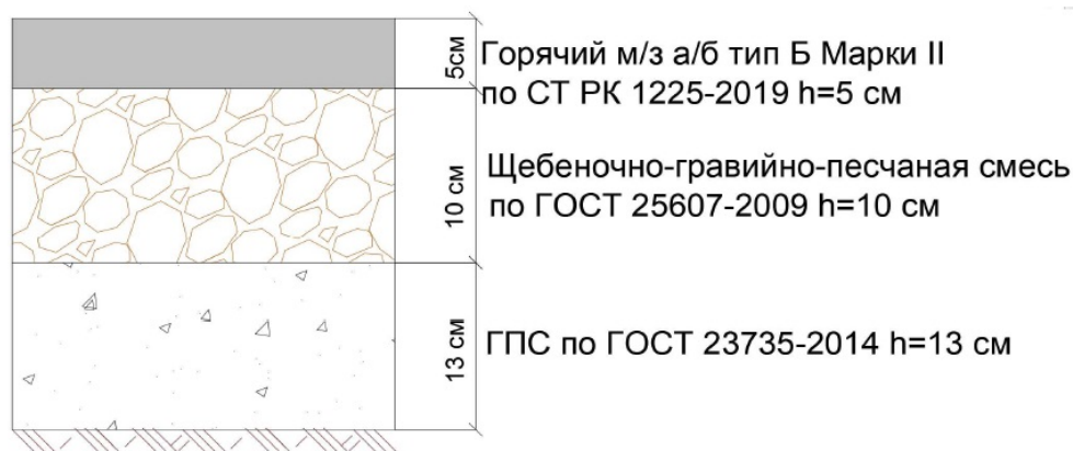
Рисунок. 5. Конструкция дорожной одежды на пешеходных тротуарах
