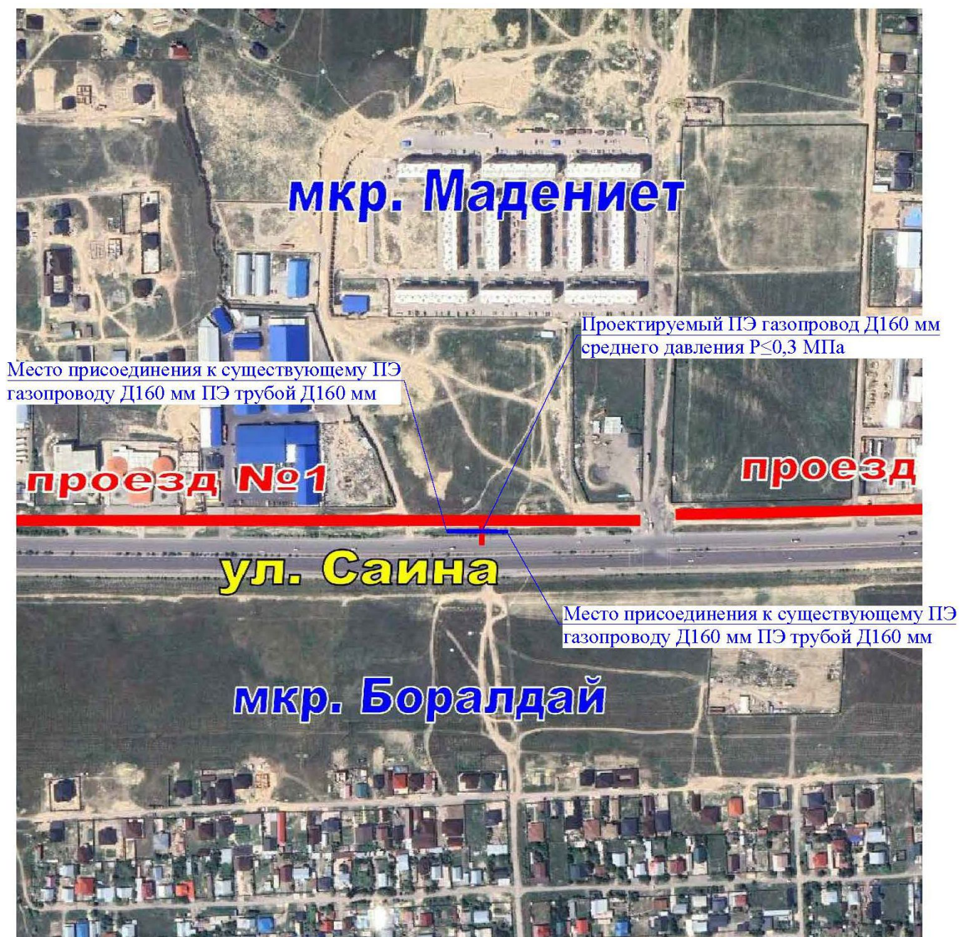
Рисунок 6 – Ситуационный план переустройства газопровода.
