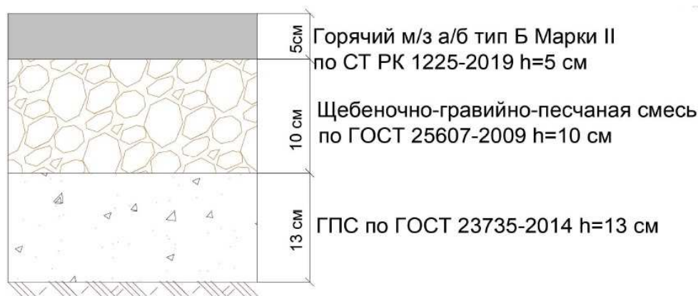
Рисунок. 5. Конструкция дорожной одежды на пешеходных тротуарах
