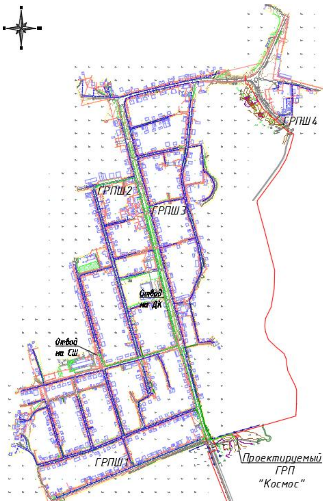
Рисунок 1.2 Схема расположения газопровода и ГРПШ внутри поселка
