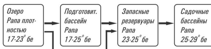
Схема заготовки рапы и осадки соли
