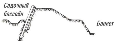
Банкет представляет собой перемычку, обшитую досками только с одной стороны. К вбитым в один ряд кольям приколачивают доски, которые на стыках скрепляют планками. С наружной стороны доски укрепляют насыпным грунтом.
