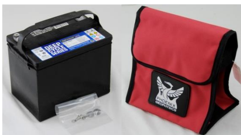
Рис. 5.6 - Система автономного питания регистраторов и генератора
