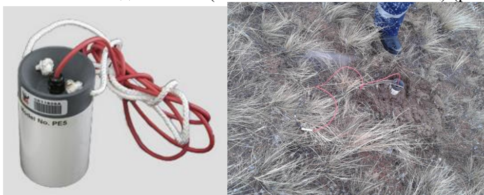
Рис. 5.9 - Неполяризующийся малощумящий электрод PE5
