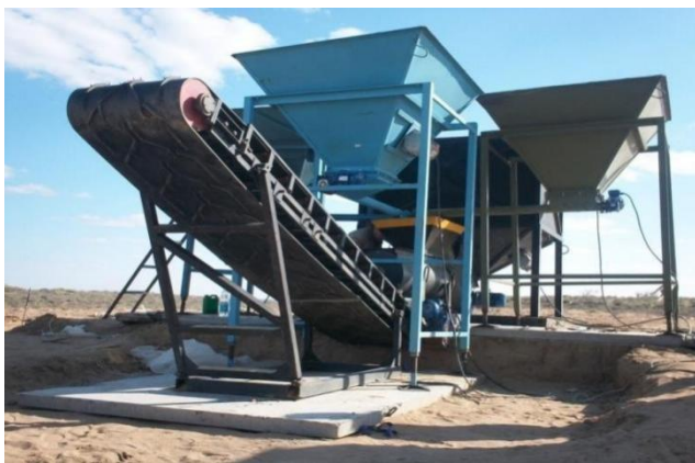
Рис.4.1.1 - Установка переработки бурового шлама-10С.
