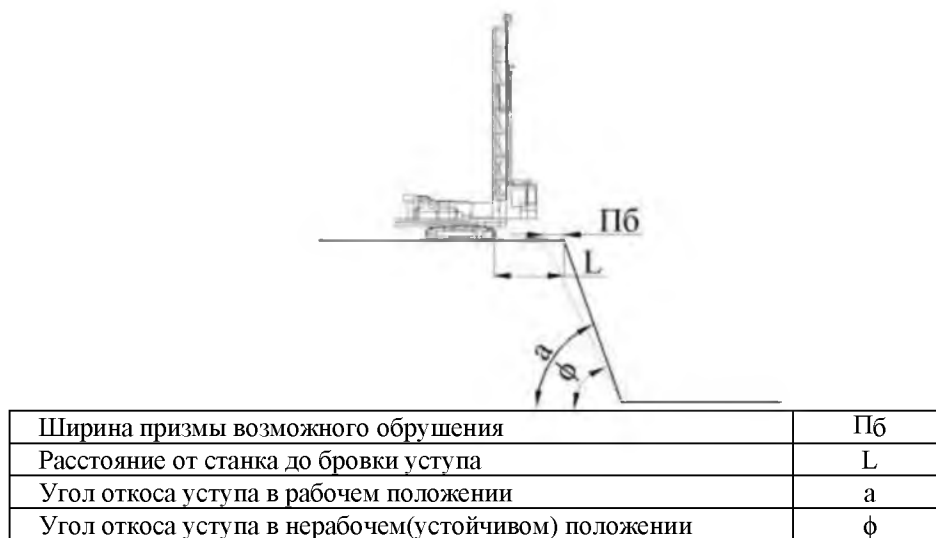
Рис. 4. Размещение бурового станка на уступе
