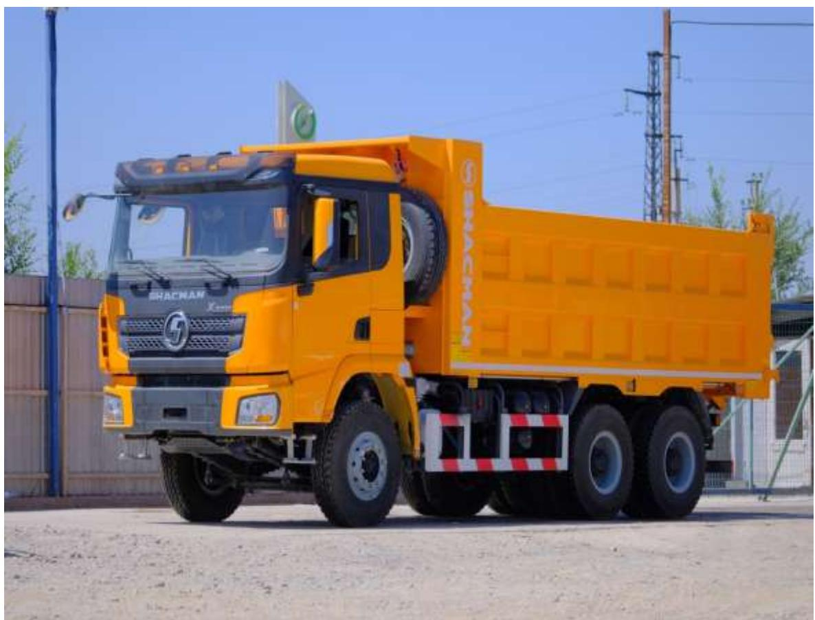
Добываемую песчано-гравийную смесь предусматривается вывозить на строящуюся автодорогу или дробильно-сортировочный комплекс автосамосвалами Shacman на расстояние 20000 м и вскрышные породы в отработанный карьер на расстояние 200 м.
